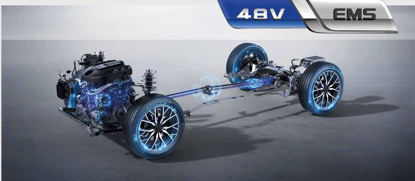
Система мягкого гибрида EMS (Electric Motor Synergy) обеспечивает эффективную совместную работу ДВС и стартер-генератора для мгновенного запуска двигателя и энергичного разгона, повышения
