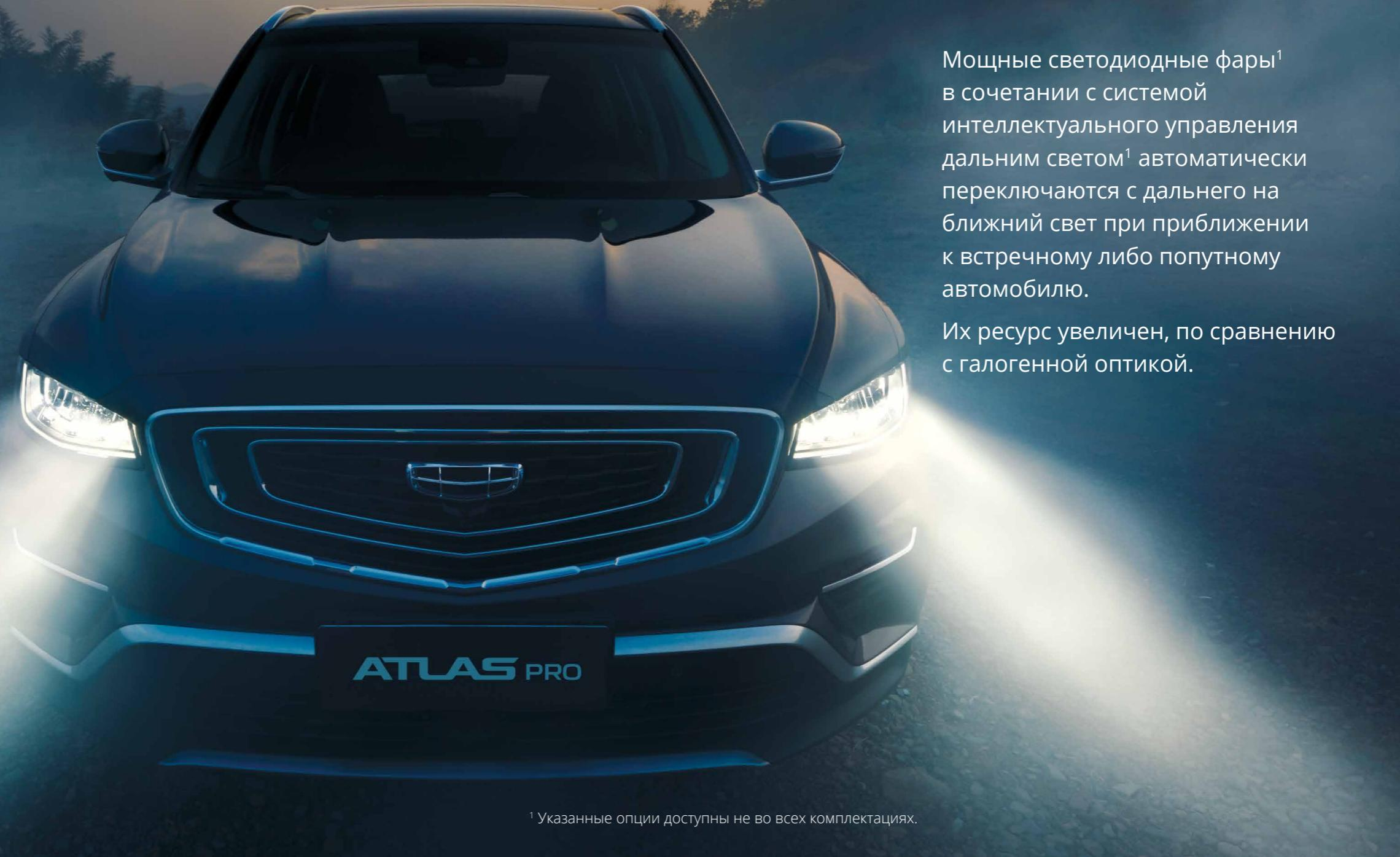
Мощные светодиодные фары<sup>1</sup> в сочетании с системой интеллектуального управления дальним светом<sup>1</sup> автоматически переключаются с дальнего на ближний свет при приближении к встречному либо попутному автомобилю.
