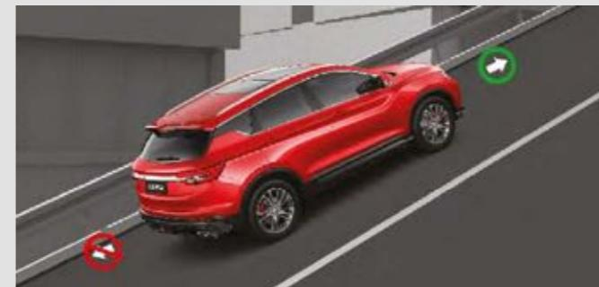
Система удерживания автомобиля при подъёме
