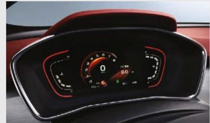
7-дюймовая цифровая приборная панель<sup>1</sup>, изменяющая дизайн в зависимости от выбранного режима движения.
