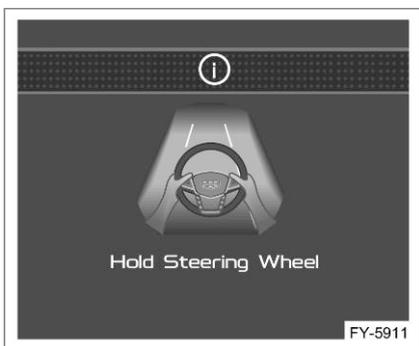
Предпосылкой для работы системы ICC является то, что водитель обеими руками держит руль. Система будет постоянно контролировать этот параметр. Если длительность снятия рук превышает определенный порог, на приборной панели будет подан сигнал о снятии рук, напоминающий водителю о необходимости держать рулевое колесо обеими руками. Если водитель не ответил, система ICC завершит работу, когда отобразится второе предупреждение о снятии рук.
