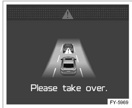
Если дистанция между транспортными средствами слишком мала, цвет впереди идущего транспортного средства, отображаемый на дисплее приборной панели, изменится на красный, а также отобразится предупреждение: «Пожалуйста, примите управление» (как на рис. выше), сопровождаемое звуковым сигналом. При получении такого предупреждения снизьте скорость, чтобы поддерживать дистанцию.
